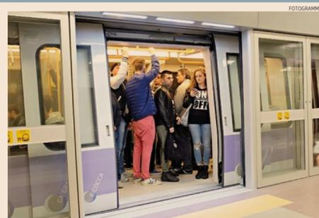
**Metropolitana senza conducente.** Un treno della linea 5 di Milano (costruttore: Hitachi Rail Italy). Tutte le stazioni hanno le banchine completamente separate dai treni tramite porte di banchina, che si aprono solo quando i treni sono completamente fermi e allineati. Tutta la linea è controllata e comandata da un'unica centrale di controllo, situata presso il deposito/officina del capolinea Bignami
